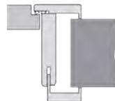
Diese Ausführung stellt eine Ergänzung zu Türelementen in Ausführung „Vario-FB“ (mit Türblatt nach außen öffnend) dar. Das Türblatt öffnet hier nach innen, die Bänder liegen verdeckt (Typ G). Die Ansicht von der bündigen Seite aus ist ident mit dem vergleichbaren Element VARIO-FB. Somit kann auch bei unterschiedlichen Türöffnungsrichtungen eine einheitliche Flächenbündigkeit von nebeneinanderstehenden Elementen erreicht werden.
